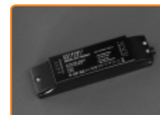
transformator LED 25W • wej cie: 220-240V-50/60Hz • wyj cie: 12V DC eff, 2A • max obci enie 25W • ochrona przed zwarcieciem KLP-2518HV
